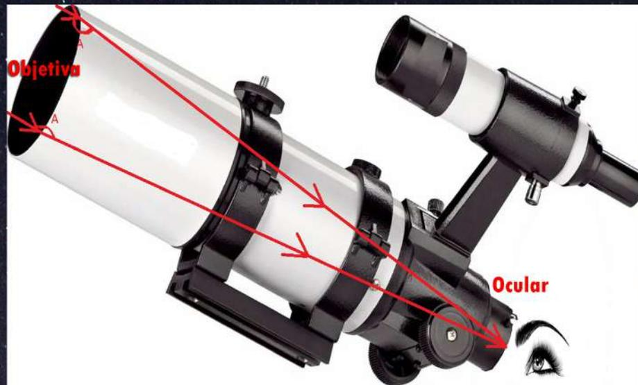
Figura59. Telescópio Refrator
